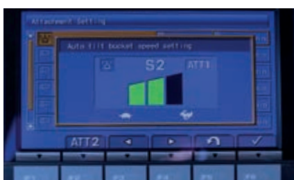
Drie in te stellen snelheden voor de auto tilt bak. Nauwkeurige vingertopbesturing
